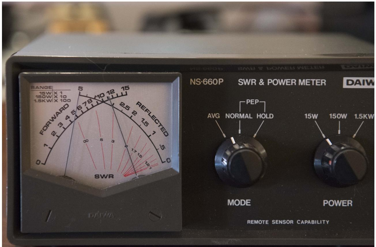
**Fig. 21.** Qui il rosmetro è posto all'uscita dell'accordatore (lato antenna), e sulla scala della potenza diretta indica circa 11 W, mentre su quella della potenza riflessa indica 5 W.
