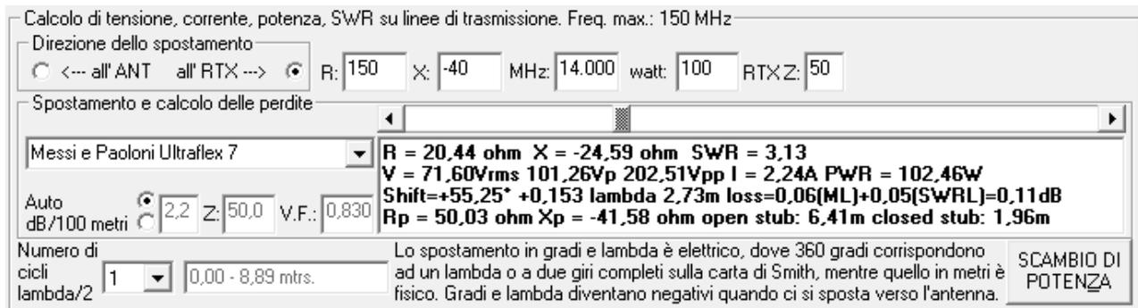
**Fig. 12. Posizione e lunghezza di un stub in parallelo.**
