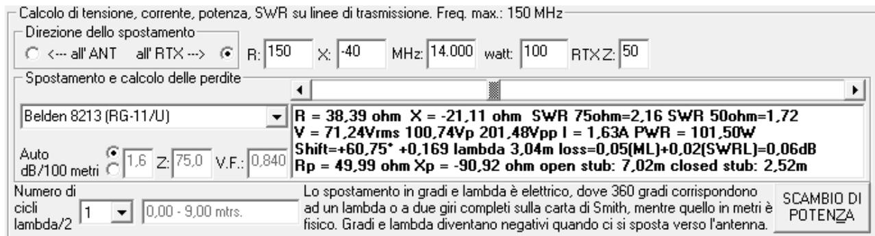
**Fig. 14. Stub con cavo di impedenza a 75 ohm.**
