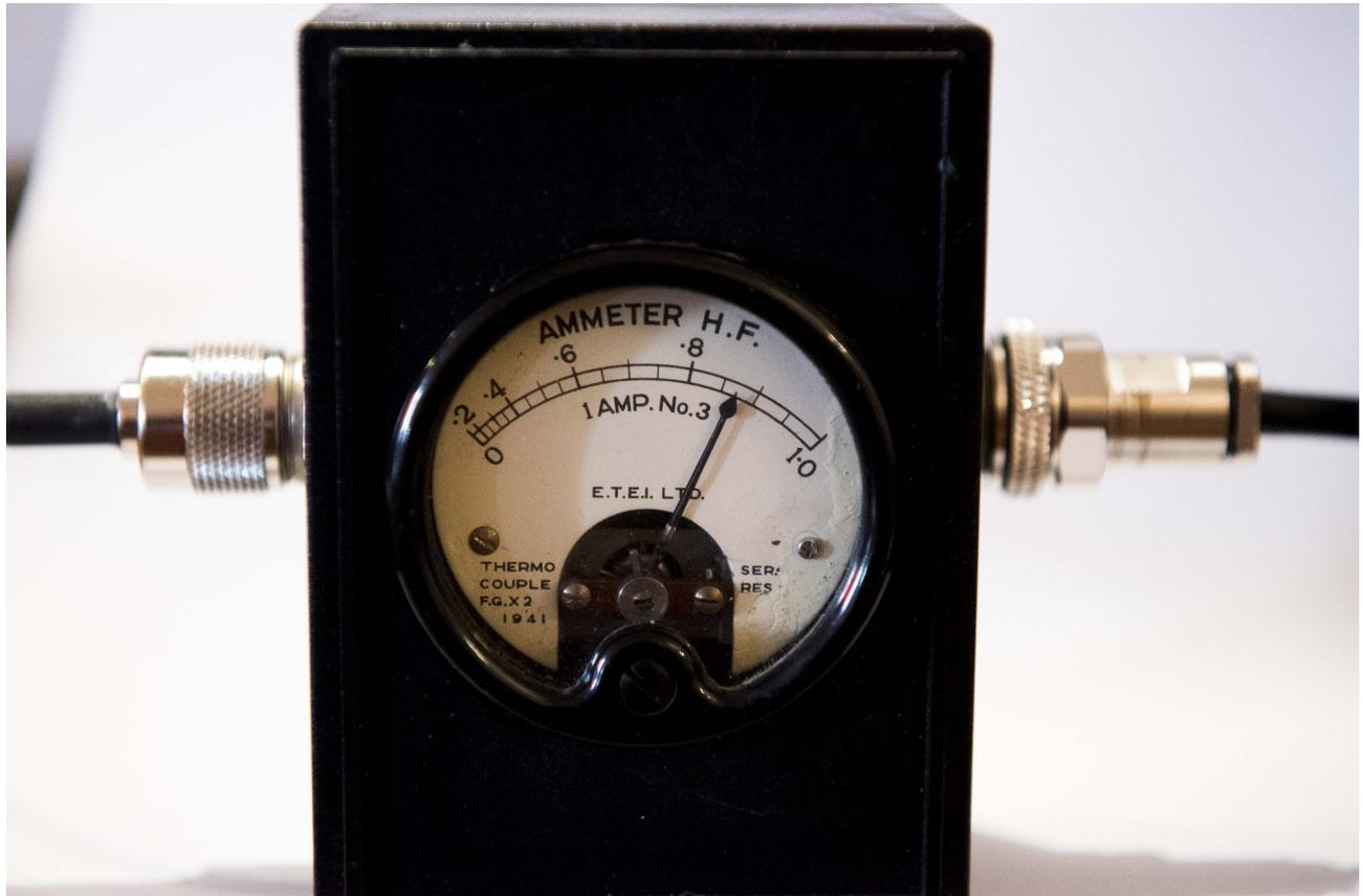
**Fig. 27. L'amperometro RF utilizzato nelle prove, uno strumento vintage a termocoppia, in grado di misurare correnti RF, nello spettro HF, fino a 1 A.**
