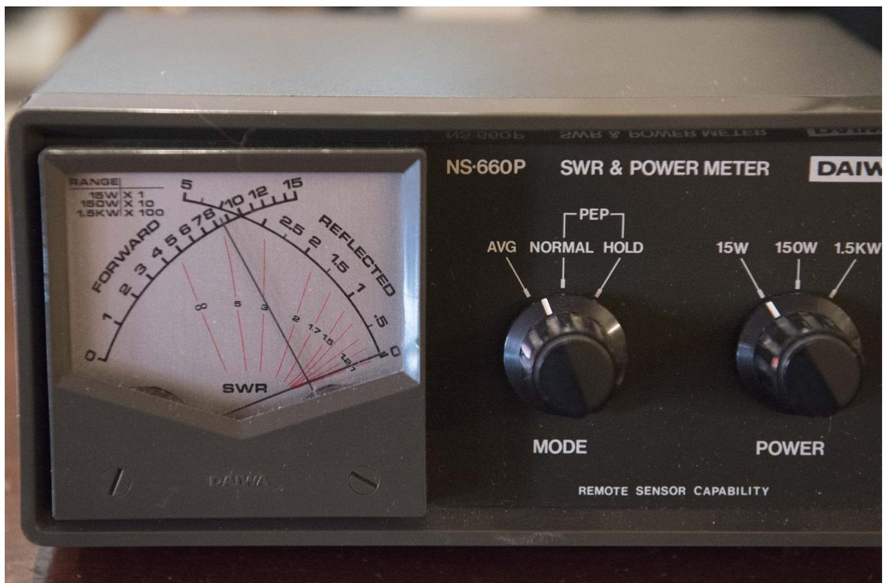
**Fig. 20. Il rosmetro ad aghi incrociati usato per le prove, modello Daiwa NS-660P, posto all'ingresso dell'accordatore (lato RTX), indica una potenza diretta di 8,5 W, ed una potenza riflessa praticamente nulla.**
